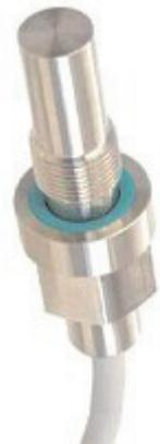
pour le système oscillateur et entraînement de ce fait une réduction de l'amplitude des oscillations au fur et à mesure de l'approche de l'objet métallique, jusqu'à blocage complet. La détection est effective lorsque la réduction de l'amplitude des oscillations est suffisante pour provoquer un changement d'état de la sortie du détecteur.
