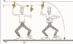
Contact indirect: contact entre un individu et une masse métallique mise accidentellement, ou suite à un défaut, sous tension.
