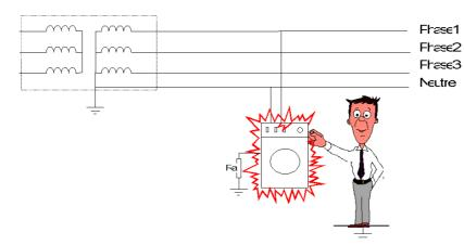
La masse de la machine est reliée à la terre. Le courant est dévié vers la résistance Ra qui doit être obligatoirement faible. Le courant de défaut est limité par la résistance de la terre et la résistance Ra:
