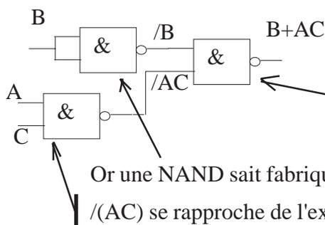
La structure à obtenir à pour équation  $S = B + AC$  elle se rapproche donc par sa forme de la relation 2. Une porte NAND pourra donc isoler B et AC. En entrée de cette porte on retrouvera alors les deux expressions complémentées.
