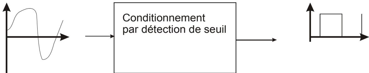
Cette mise en forme se fait en comparant la tension analogique avec une tension constante.
