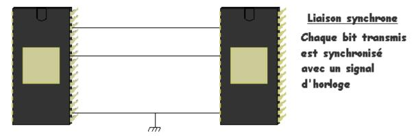
Cette liaison présente l'inconvénient de nécessiter trois fils entre l'émetteur et le récepteur. Une liaison **asynchrone**, évite cela mais impose la présente de bits de synchronisation (**start** et **stop**).
