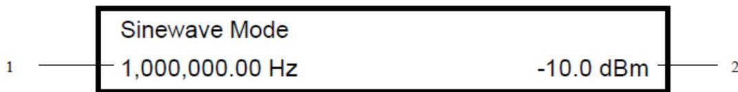
2. Dans le champ de la fréquence (1) saisir la valeur avec le pavé numérique et valider par le bouton d'unité : MHz, KHz ou Hz.
