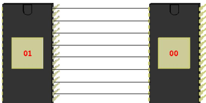
parallèle est d'assurer cette liaison entre "l'extérieur" et le microprocesseur. Pour ce faire, il dispose généralement d'un registre de configuration, d'un registre d'entrée sortie, et est en liaison avec le microprocesseur par l'intermédiaire du bus de donnée et du bus d'adresse.
