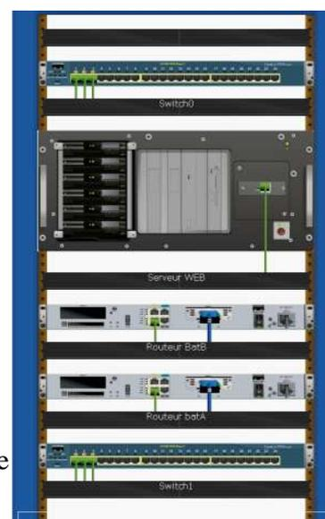
Pour relier les différents équipements entre eux on utilise des câbles informatiques disposants à leur extrémité des connecteurs RJ45 (norme NFC-15-100).
