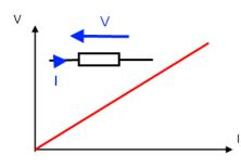
Une caractéristique de transfert représente sur un système d'axe deux grandeurs électriques la grandeur d'entrée d'une fonction (souvent représenté en abscisse) et la grandeur de sortie de cette même fonction. Par exemple V=f(I) représente l'impédance d'une fonction.
