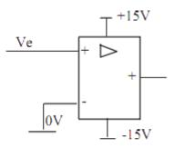
Dans l'exemple ci-dessus, la comparaison du signal d'entrée se fait avec 0V.
