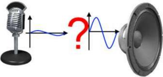
La solution : Alimenter le Haut Parleur avec une tension plus importante (et aussi un courant suffisant) mais proportionnelle à celle sortant du microphone.
