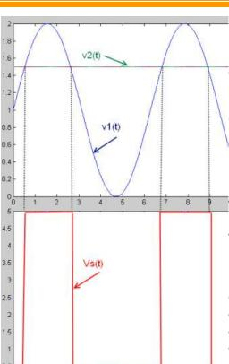
En soustrayant un signal à un autre et en l'amplifiant très fortement - au point de saturer l'amplificateur - on réalise une structure capable de comparer une tension à une autre et de restituer un signal logique.
