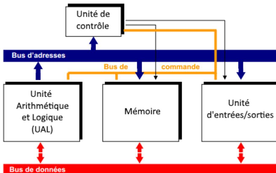
Les données (codes de programme et données) sont véhiculées par un ensemble de fils appelé **BUS DE DONNEES**. Le bus de données est bidirectionnel et son nombre de fil dépend de la capacité de traitement du microprocesseur. 8 fils s'il s'agit d'un microprocesseur 8 bits.
