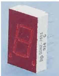
En associant 7 LED, on obtient un afficheur utilisé pour indiquer des valeurs numériques.
